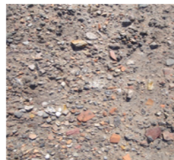
Zu feinen Fragmenten verwittertes Asbestzementdach, nur schwer identifizierbar
