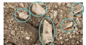
Zu feinen Fragmenten verwittertes Asbestzementdach, nur schwer identifizierbar
